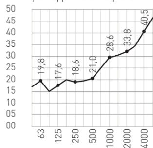
**Absorption phonique** Isolement acoustique normalisé par rapport à la fréquence
